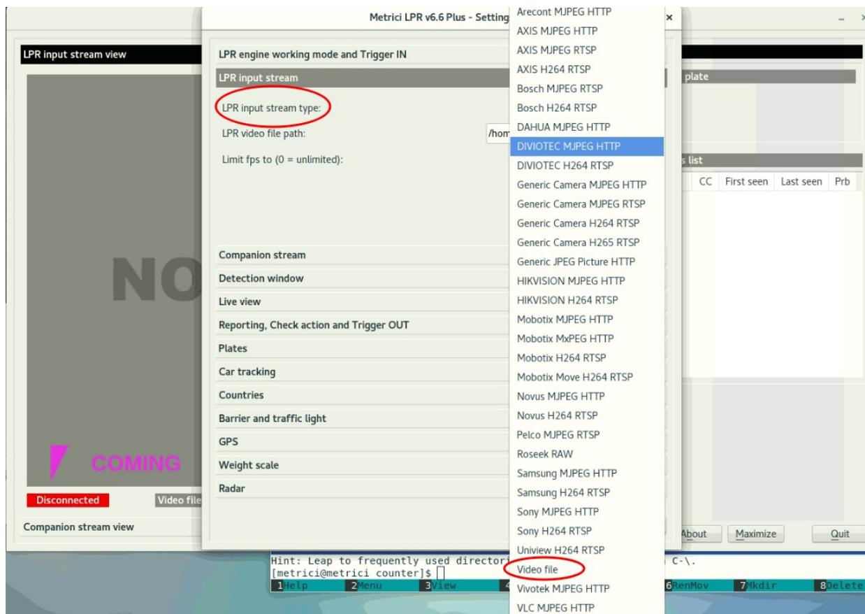
Apoi la meniul LPR Video File Path este calea spre unde se vor salva fisierele care vor fi analizate: in exemplul nostru fisierele vor fi salvate in home/metrici/counter, unde 54.avi reprezinta ID-ul camerei care a fost generat de Metrici cand camera a fost introdusa in Interfata, iar extensia .avi arata ca Metrici va analiza doar fisiere avi. Daca se doreste ca fisierele analizate sa fie mp4, atunci se va schimba extensia in acest sens, dar ID de camera ramane 54.
