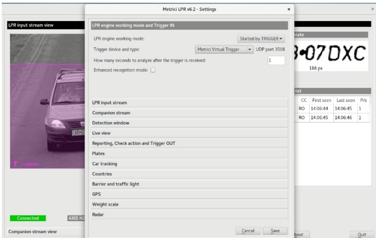
Daca toate campurile au fost completate corect si setate corespunzator, in momentul deschiderii unei bariere din liveview din Interfata Metrici este trimis si un trigger spre motorul LPR si se capteaza o imagine de pe camera cu ID-ul respectiv
