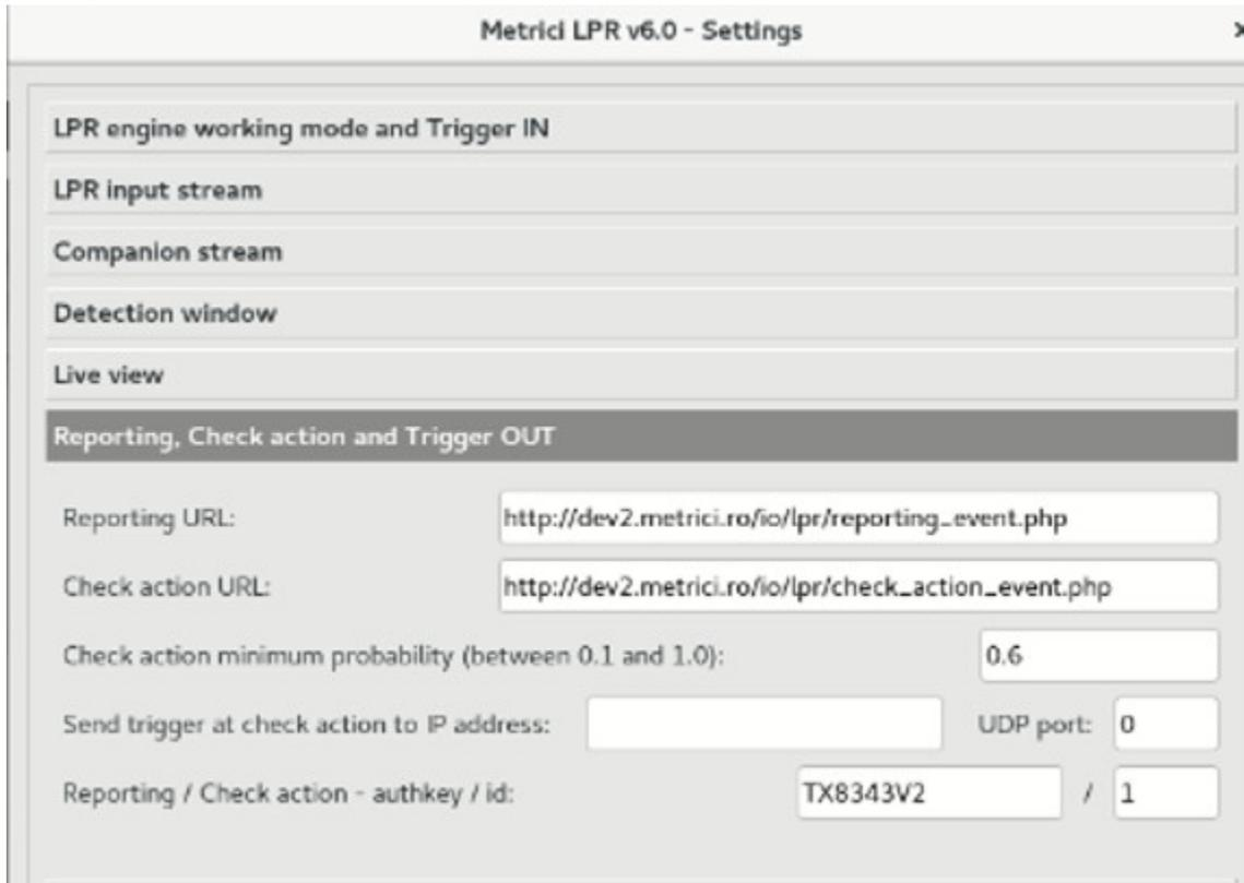
**Send trigger at check action to IP address** este util in situatiile de cross checking cand se doreste ca doua evenimente sa fie inregistrate impreuna in baza de date. De exemplu, la o statie de cantarire o detectie LPR in fata camionului genereaza un eveniment LPR si pentru spatele camionului.
