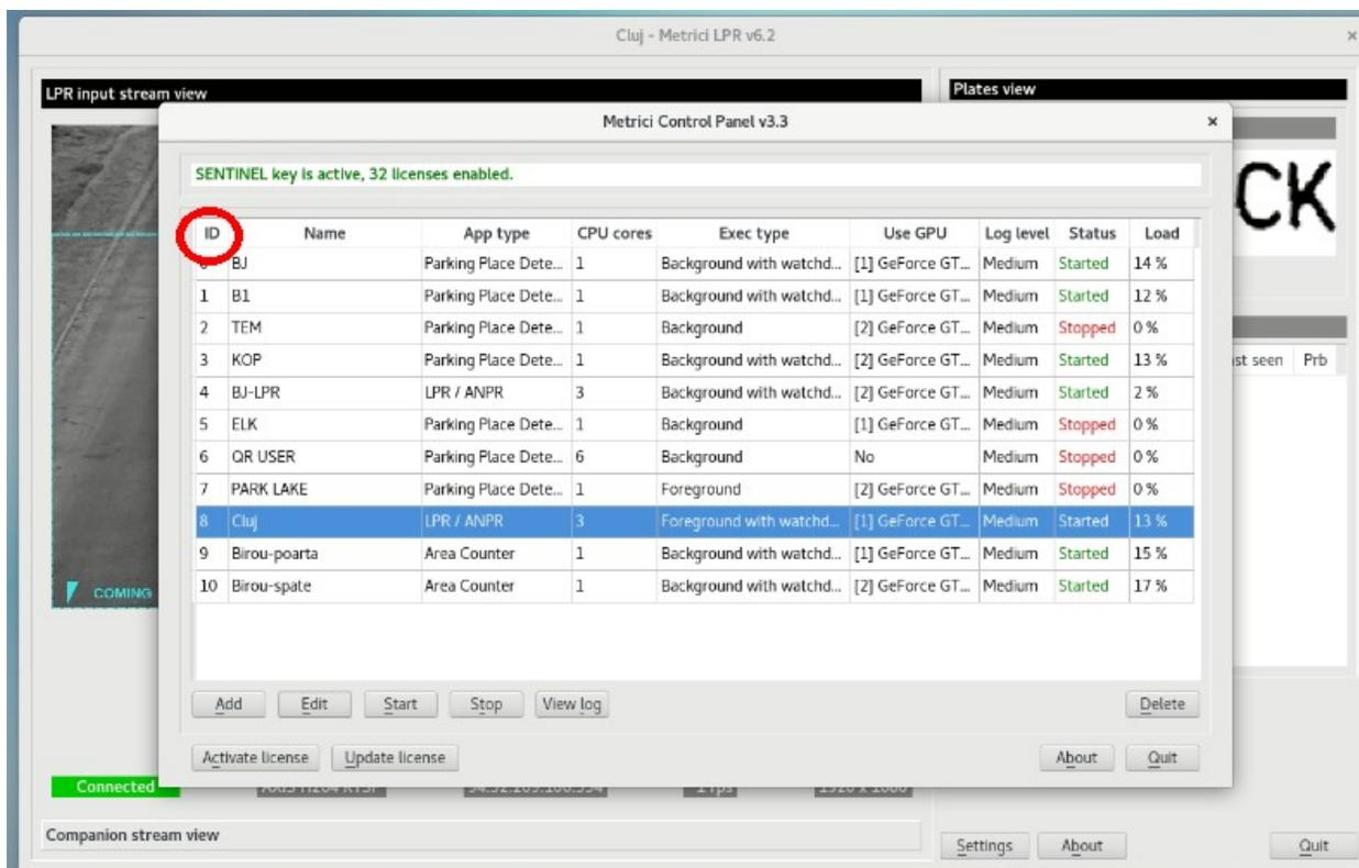
Pentru o functionare corecta, se va mai selecta **Metrici Virtual Trigger** in Metrici Control Panel. Se selecteaza o camera, se trece in **Foreground with watchdog** si se acceseaza setarile acesteia.
