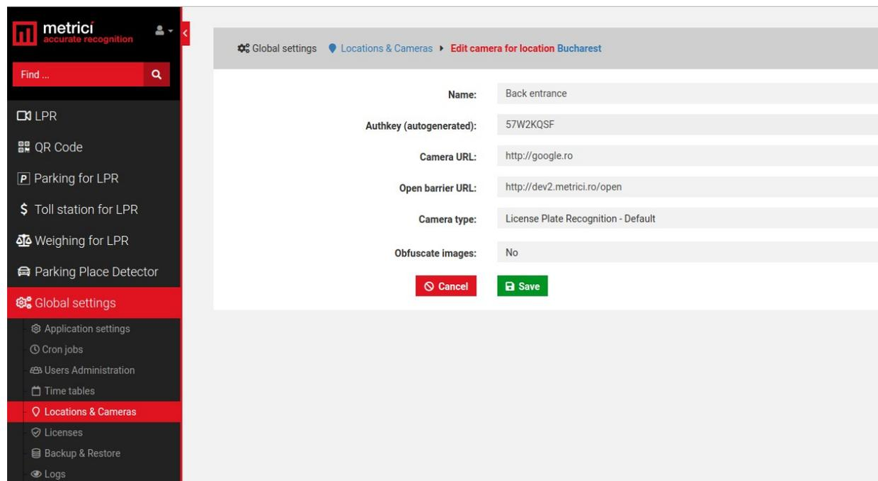
Dupa ce toate camerele au fost introduse in sistem, veti vedea o lista precum in imaginea urmatoare. ID si si authkey pentru fiecare camera ESTE OBLIGATORIU sa fie introduse in **Metrici Control Panel** – anume la motoarele de detectie. Acesta poate fi pe acelasi server sau un altul, diferit.
